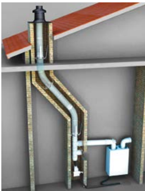
Sistema misto flex/rigido con sifone condensa. Straight/flexible pipe with condensation trap.
