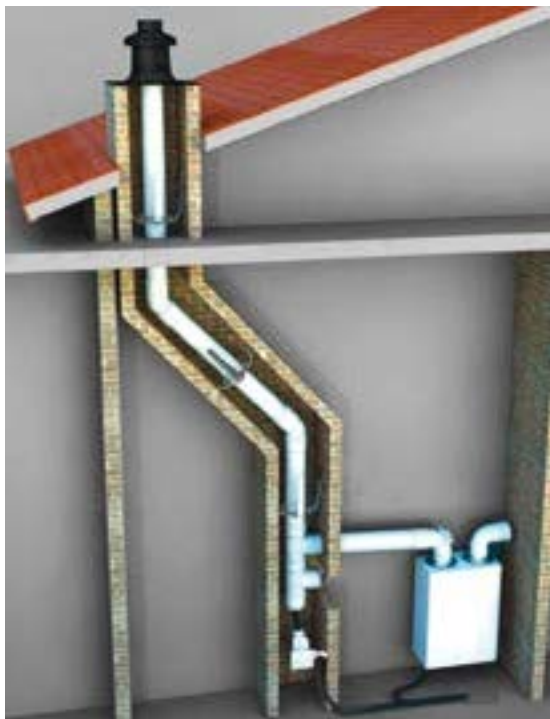
Condotto interamente rigido con sifone condensa. Entirely straight pipe with condensation trap.
