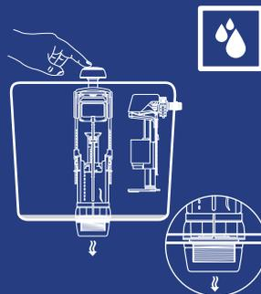
El tanque se vacía más rápido que el mecanismo de retardo, mientras que la válvula de flotador permanece cerrada.
