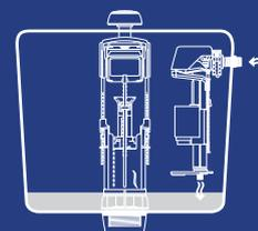
Una vez que ha terminado de vaciar el agua de la cisterna, la válvula de descarga se cierra, es entonces cuando la válvula de llenado comienza a llenar nuevamente la cisterna. Con este proceso evitamos que se mezcle el agua que entra con la que sale hacia el inodoro.
