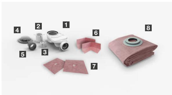
1- Dreno a escolher (RUBER H50 ou RUBER H28). 2- Coroa RUBER. 3- Filtro para cabelos. 4- Tampa de nível de argamassa. 5- Redutor Ø50/40 (somente com RUBER H50) 6- W-S DIN x2 (canto interior). 7- W-S TUB x2 (tubos passantes). 8- Tela WATER-STOP com adaptador termo-selado.
