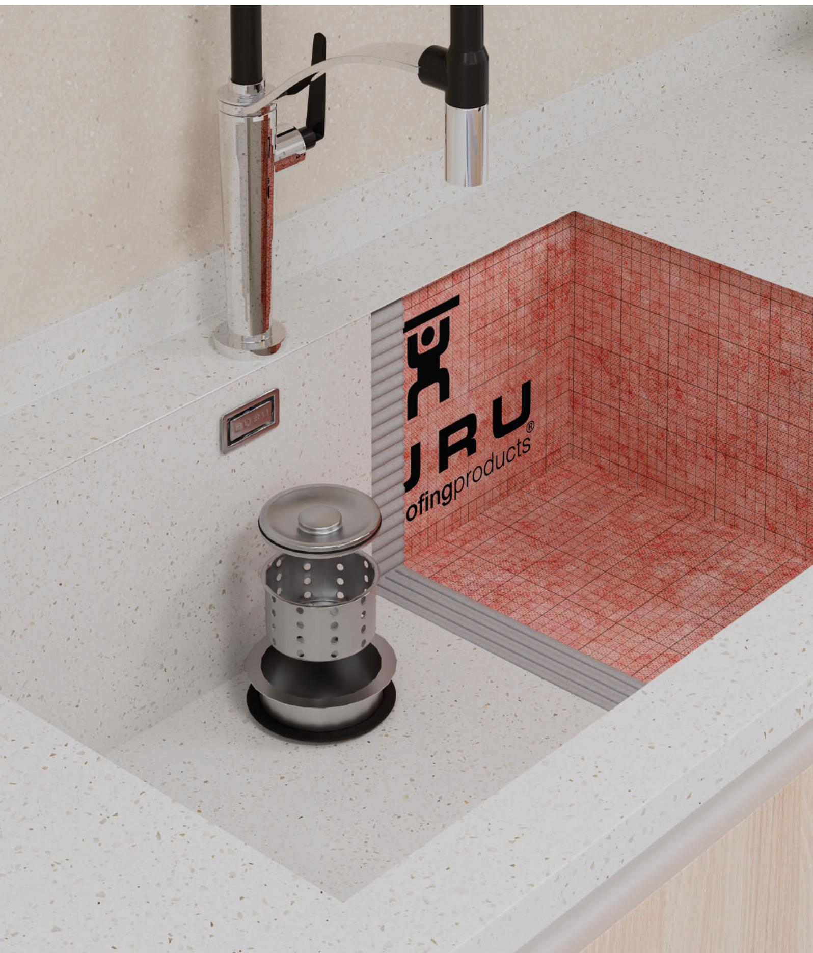
O W-S SINK é uma pia de cozinha **impermeabilizada** fabricada com os nossos painéis W-S BOARD, o que garante estanqueidade e oferece maior **durabilidade**. A pia conta com uma base pré-inclinada e é apresentada **pronta para ser instalada**, com um interior que pode ser **revestido** diretamente com azulejos cerâmicos ou microcimento.
