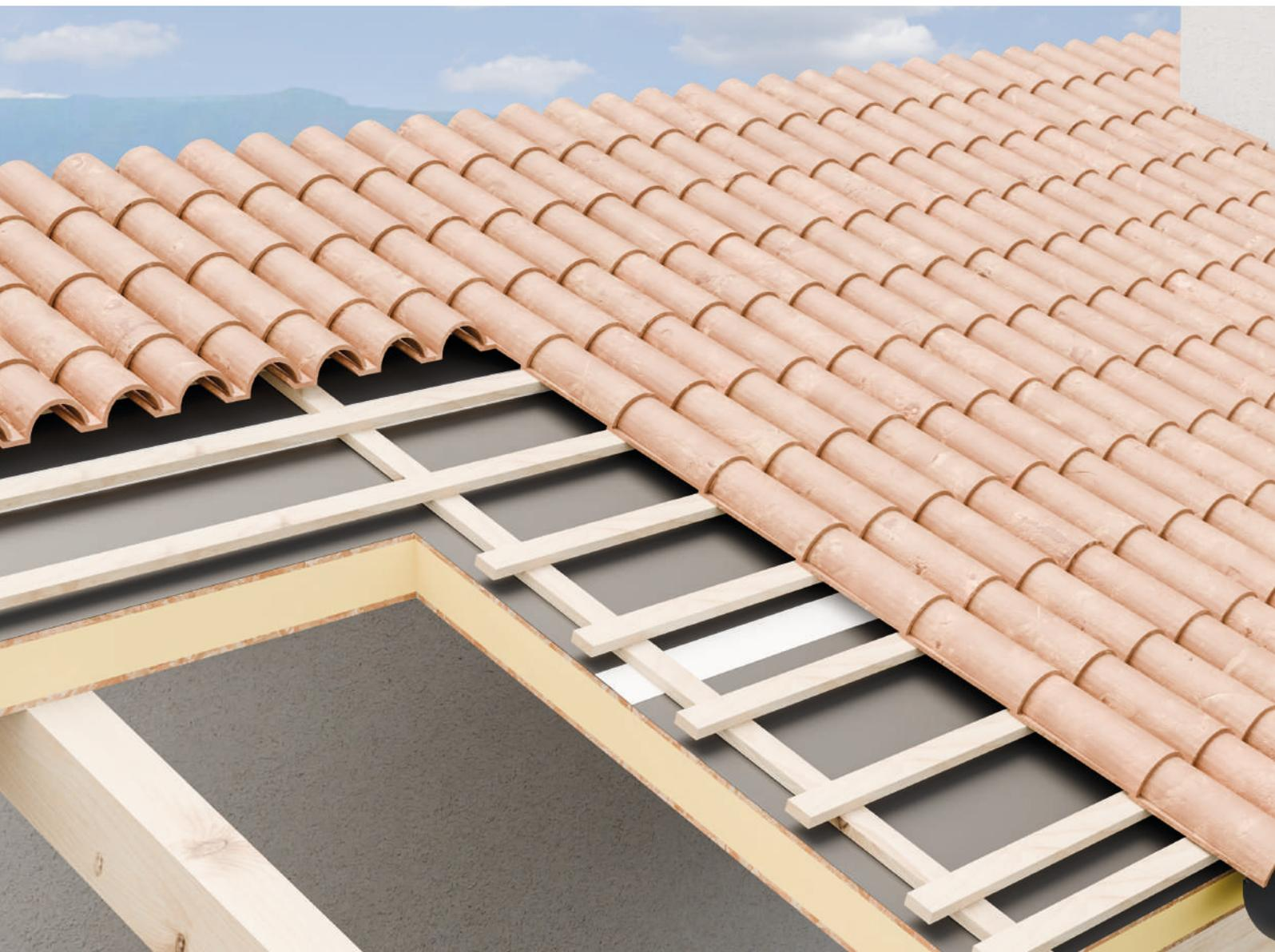
É uma lâmina impermeável à água e permeável ao vapor de água utilizada para o controlo do vapor em coberturas inclinadas e fachadas ventiladas, a ser instalada sob a proteção e sobre a estrutura de suporte, apoiando nas vigas ou no painel (laje de betão, madeiras, painéis...) ou diretamente sobre o isolamento térmico.
